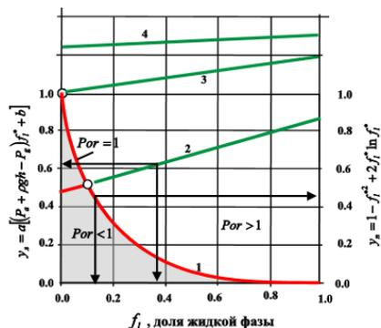
**Рис. 3.** Графическая интерпретация решений неравенства (33) при малой газонасыщенности
