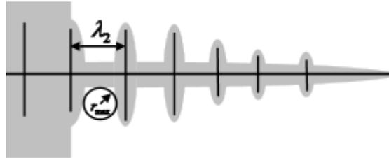
**Рис. 2.** Схема к понятию геометрического ограничения для формирования усадочной поры в двухфазной зоне.
