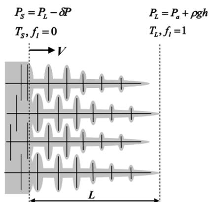
Рис. 1. Модельная схема двухфазной зоны
