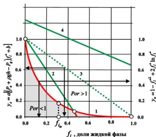
**Рис. 4.** Графическая интерпретация решений неравенства (33) при большой газонасыщенности расплава. Прямая 2 соответствует решению неравенства (33), при котором пористость образуется, прямые 3, 4 - пористость не образуется.
